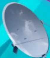
Код сателитске антене таласе се скупљају у жижи параболе где је пријемник.
